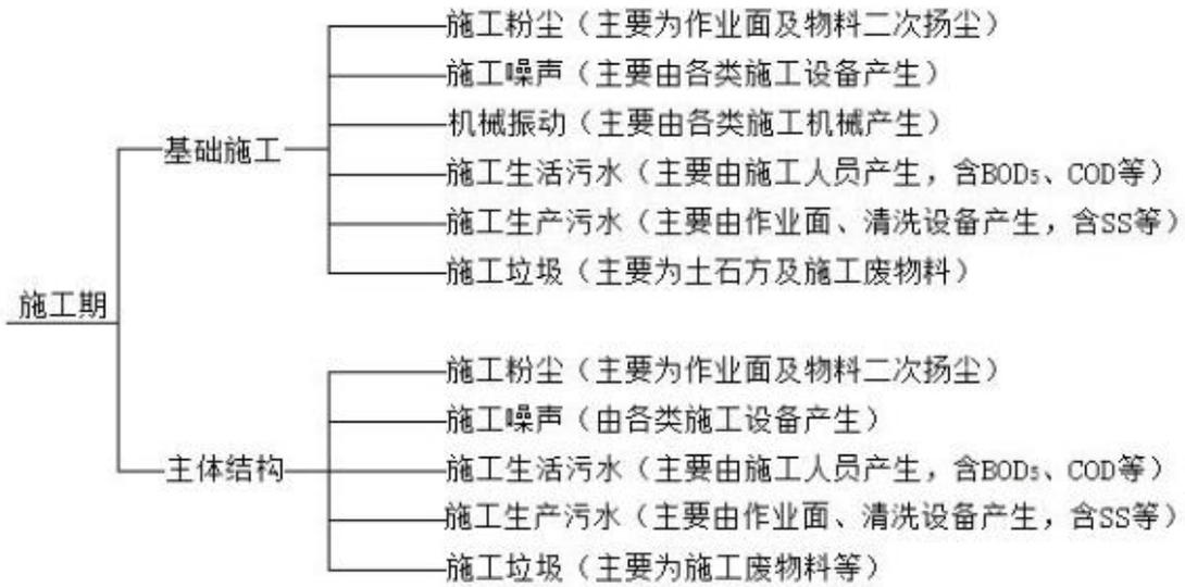
图 2-1 项目施工期工艺流程及产污环节
