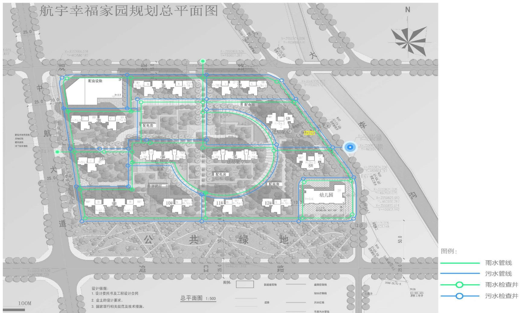
附图3 建设项目雨污分流管网图
